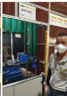
焊接车间分隔防护
