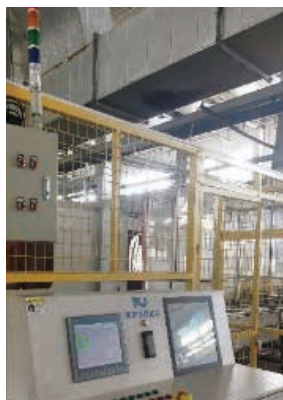
雕铣机及挤型机安全 防护升级，电气主控 系统置于外侧，大幅 降低操控和编程时风 险
