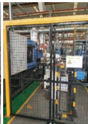
塑胶厂自动化机械 安全连锁装置
