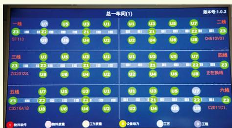
生產線的安燈系統也是任何異常快速反應機制的一部分。該安燈系統通過三色燈、蜂鳴以及IT信息的傳遞，實時地反饋各生產單元內的生產狀態(如正常、異常待處理或處理中)。該系統大大縮短了異常處理時長，提高了生產效率，也是我們進行統計、應用、評價及分析的數據來源。
